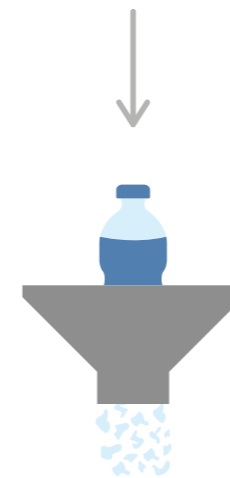
Escamas de Botellas y Masterbatch Las botellas PET se limpian, se trituran en escamas y se combinan con masterbatch para mejorar el color y el rendimiento.
